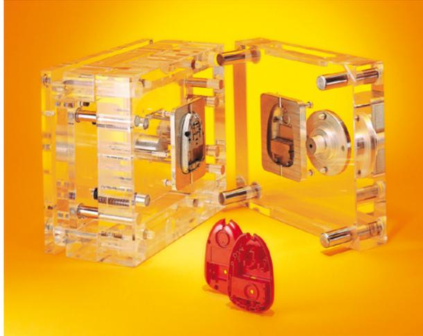
**Bild 5.5** Prinzipieller Aufbau eines Spritzgießwerkzeugs Die Platten wurden zur Demonstration aus Plexiglas gefertigt.
