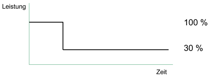
Bild 2.5 Leistungskurve „partieller Fehler“
