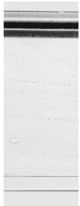
Abb. 2.1 Maßstabsgerecht vergrößerter Querschnitt durch Negativ-Filmmaterial mit drei farbsensitiven Schichten [6]
