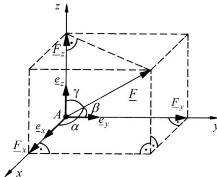
Abb. 1.1.2: Kraftvektor, im Raum aufgespannt im kartesischen Dreibein.
