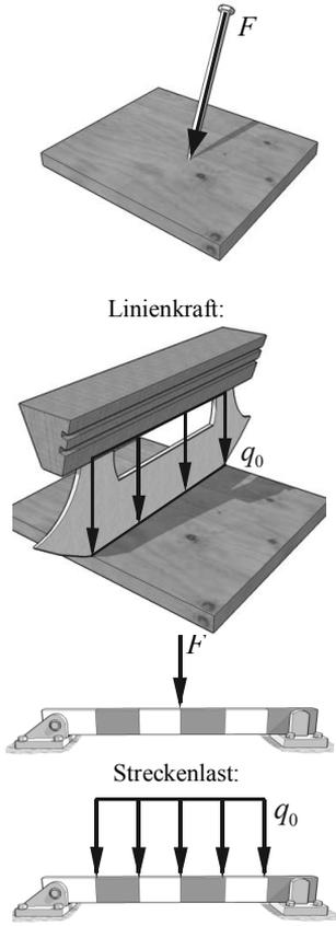
Abb. 1.1.3: Zum Begriff der Einzellast oder Linienkraft.
