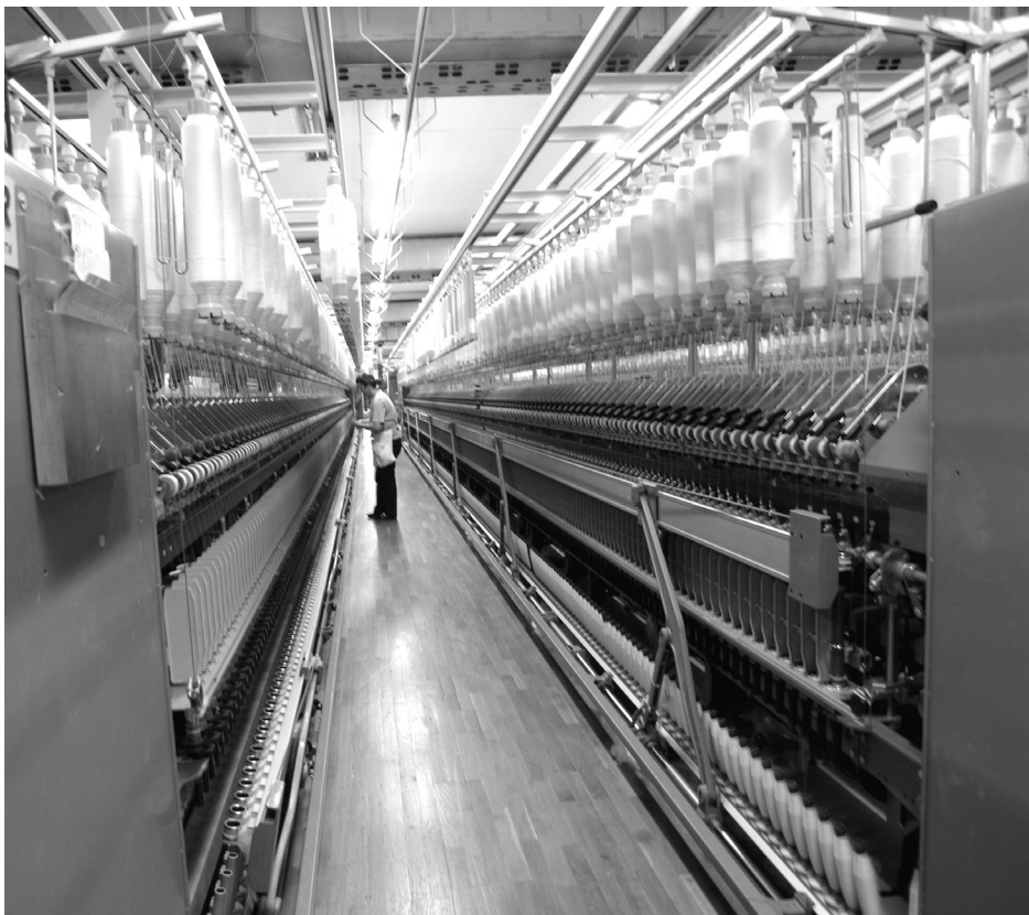
Bild 1.1 Ringspinmaschinen in einer Spinnerei (Foto: Lauffenmühle GmbH & Co.)
