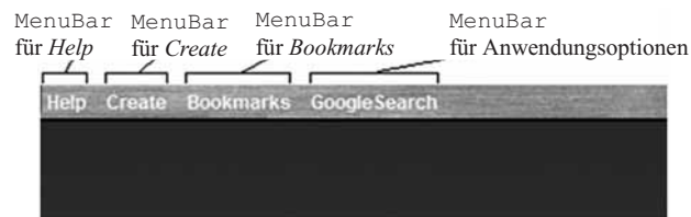
Abbildung 4.9 Das Dashboard-Menüsystem mit den vier möglichen Menüleisten. Die Menüleisten HELP und CREATE sind stets vorhanden, das Menü BOOKMARKS wird als XML-Code vom Server geladen, und die Optionsmenüleiste wird bei Aktivierung einer Komponentenanwendung angezeigt.
