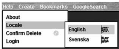
Abbildung 4.10 Menüsystem des Dashboards mit den beiden neuen MenuItem -Widgets, die in diesem Kapitel erstellt werden. Die Menüelemente für das englische und das schwedische Gebietsschema sind Instanzen von TwoComponentMenuItem , das Element CONFIRM DELETE eine Instanz von ToggleMenuItem (wird mit dem Status EIN angezeigt).
