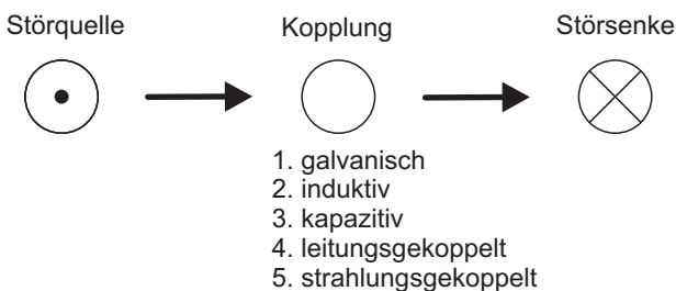
Bild 2.1 Elementares Beeinflussungsmodell: Eine Störquelle emittiert eine Störaussendung, die durch einen Kopplungsmechanismus an der Senke zur Störgröße wird.
