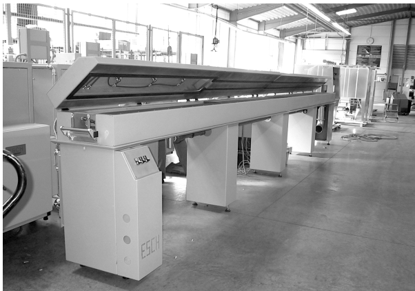
Bild 5.2: Kaltwassersprühkühlstrecke (Foto: Fa. HSM GmbH)
