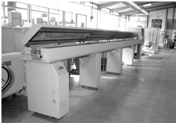
Bild 5.2: Kaltwassersprühkühlstrecke (Foto: Fa. HSM GmbH)
