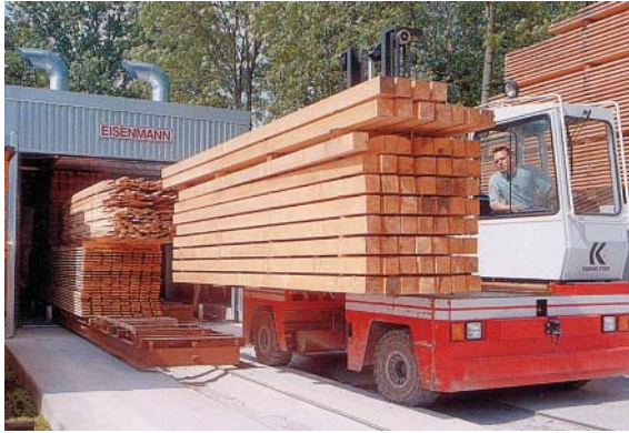
Bild 9-8 Beschickung einer Trockenkammer mit Bauholz. Ein Gleiswagen wird durch einen Seitenstapler beladen (Bild: EISENMANN)
