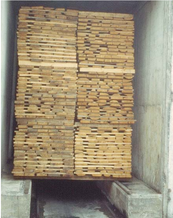
Bild 9-10 Stapel sind durch einen Hubwagen auf zwei Mauerbänken in der Kammer abgestellt worden
