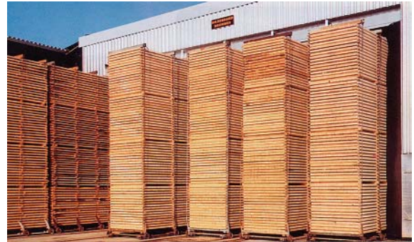
Bild 9-7 Beschickseite eines großen Trockenkanals mit Längsanordnung der Stapel, kontinuierlich gefördert auf Rollenböcken (Bild: BRUNNER-HILDEBRAND)
