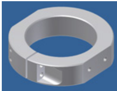
Bild 4.3: Übungsbeispiel aus einem 3D-CAD-Grundkurs: Klemmring
