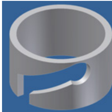
Bild 4.5: Übungsbeispiel aus einem 3D-CAD-Grundkurs: Kupplung
