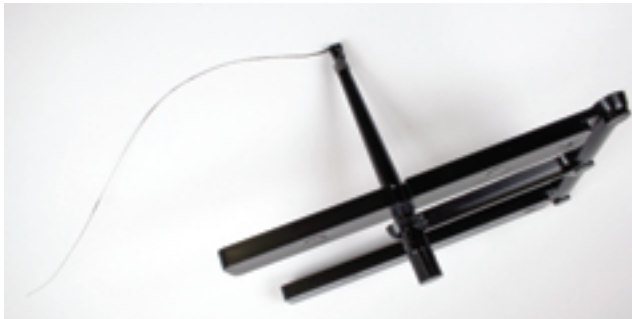
Bild 2.2 Fadenbildung an der Angussstange
