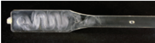
Bild 2.6 Formteil aus amorphem Kunststoff mit Freistrahlsbildung; Freistrahls liegt als kalte Seele eingebettet im Formteil
