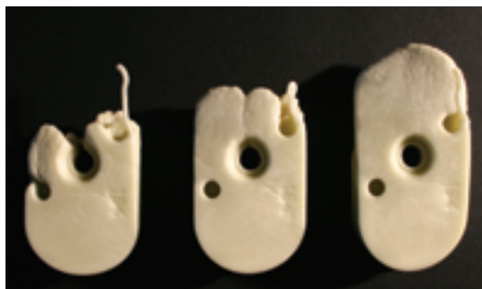
Bild 2.7 Partielle Freistrahlsbildung im Inneren eines Formteils während seiner Herstellung
