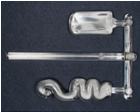
Bild 2.4 Auswirkung eines Fächer- und Punktanschnitts auf die mögliche Ausbildung eines Freistrahls während der Formfüllung
