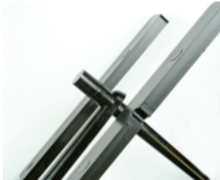
Bild 2.3 Pfröpfen in Verlängerung der Angussstange (auswerferseitig)
