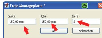
Mit Klick auf den Button OK platziert EPLAN die Montageplatte mit genau den Abmessungen wie manuell vorgegeben.
