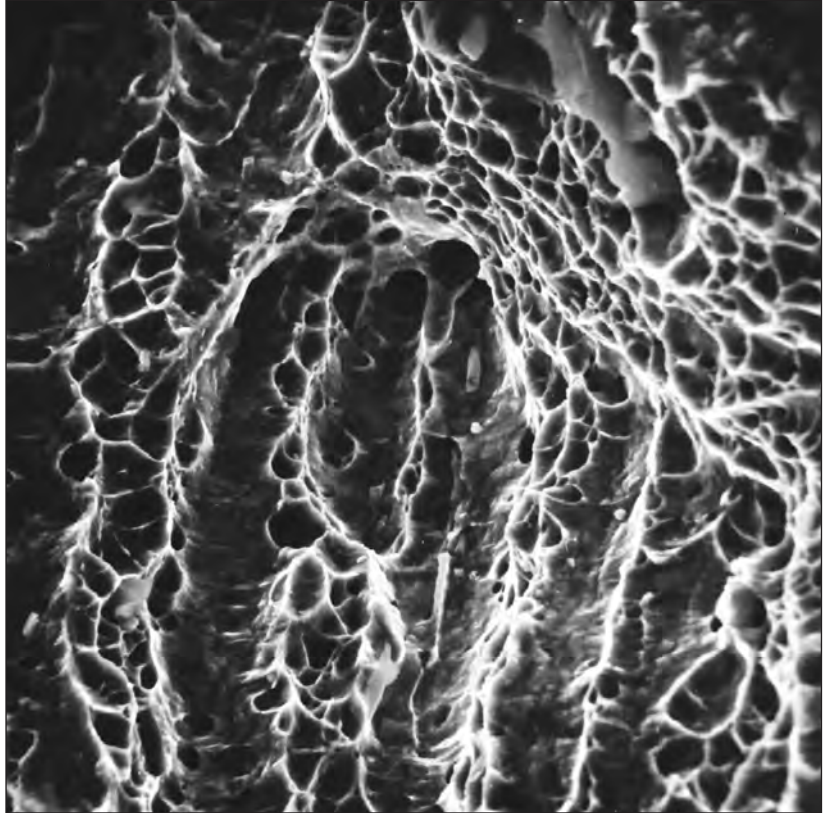
Bild 47: Zeilige Wabenstruktur um Mangansulfidzeilen beim zähen Bruch eines Stahls. 1000:1
