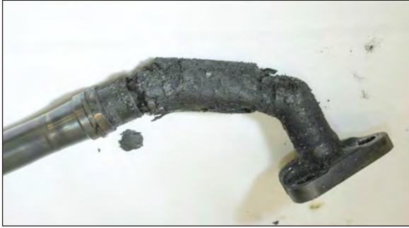
Abb. 5: Öldruckleitung mit verbranntem Isolationsmaterial
