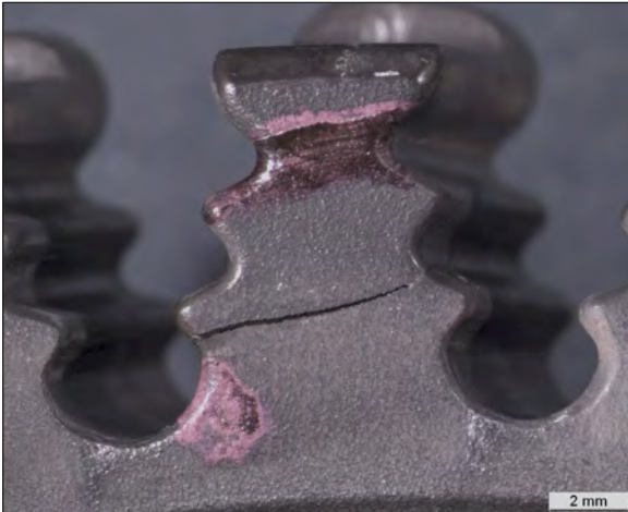
Abb. 4 und 5: Rissbefunde in der Schaufelaufnahme, die Lage der Risse ist identisch mit der Bruchebene
