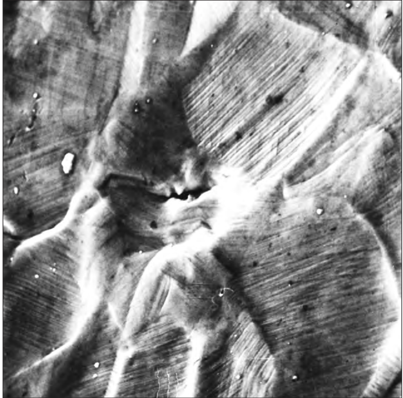
Bild 43: Gleitlinien und ein Anriss auf der Zugseite eines elektrolytisch polierten und anschließend gebogenen Bleches aus Nickelwerkstoff mit Cr, Fe und Ti. 5000:1
