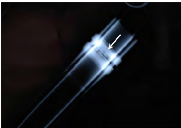
Abb. 9: Auf dem Röntgenfilm ist die Wurzelüberhöhung deutlich sichtbar
