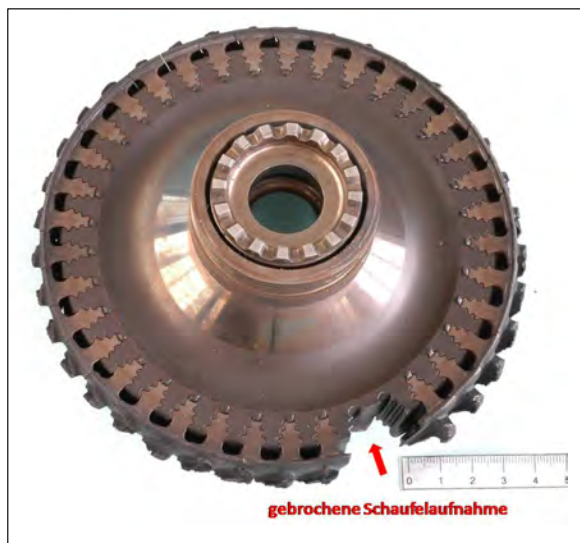
Abb. 1 und 2: Darstellung der gebrochenen Schaufelaufnahme
