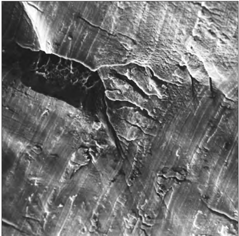
Bild 44: Zähle Anrisse mit Wabenstruktur in einem hochlegierten Stahl. An der Oberfläche sind die Gleitspuren zu erkennen. 600:1
