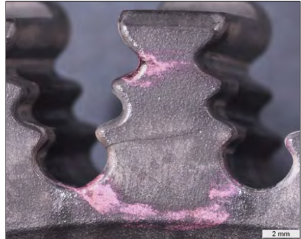
Abb. 4 und 5: Rissbefunde in der Schaufelaufnahme, die Lage der Risse ist identisch mit der Bruchebene
