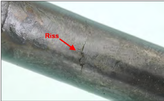
Abb. 7: In Umfangsrichtung verlaufender Riss
