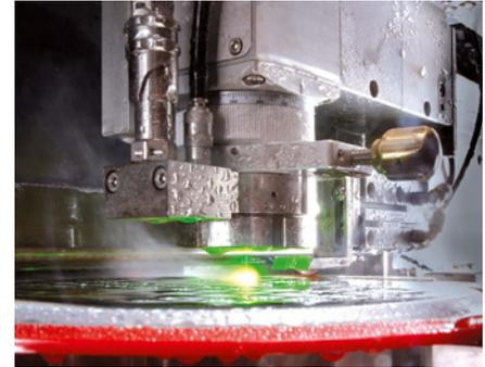
**Abbildung 14.11** Laserschneiden: detaillierter Blick mit wasserstrahlgeführten Laser
