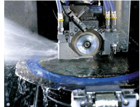
**Abbildung 14.7** Blick auf rotierendes Sägeblatt mit Wasserkühlung
