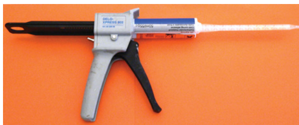
Bild 5.9.13 Koaxiale Doppelkartusche mit mechanisierter Betätigung
