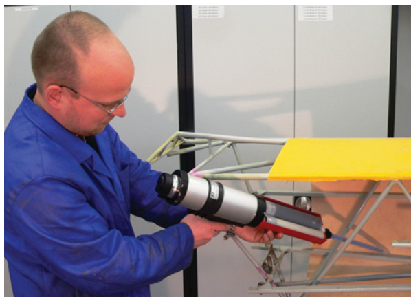
Bild 5.9.14 Klebstoffauftrag aus großer Doppelkartusche mit Druckluftbetätigung und langem statischen Mischrohr
