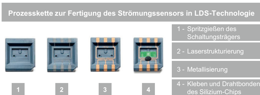
BILD 9.2 Strömungssensor für Volumenstromregler [Bildquelle: 2E mechatronic]
