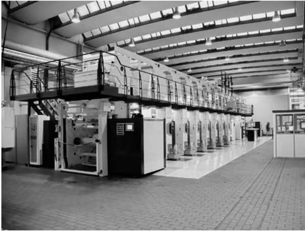
**Bild 4.41** Rollentiefdruckmaschine für den Foliendruck (Werkbild: Windmüller & Hölscher KG)
