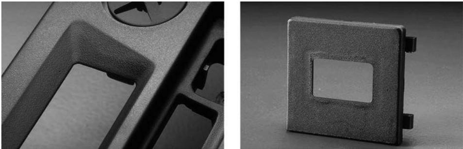
**Bild 10.2** Glanzunterschiede an Kunststoff-Formteilen [1]
