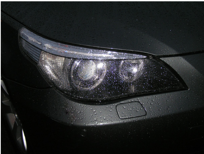
Bild 3.28 Die Verglasung für Autoscheinwerfer besteht aus Polycarbonat und wird mit einer dünnen Schicht aus Siloxan beschichtet, um die Kratzfestigkeit, den UV-Schutz und den Schutz vor Lösungsmitteln zu erhöhen.
