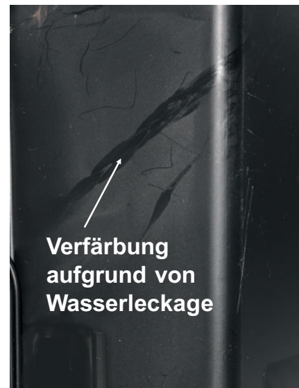
Bild 29.24 Die diagonale Markierung auf der Oberfläche ist entstanden, als Kunststoffschmelze in der Kavität mit Wasser in Kontakt kam.
