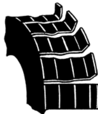
Bild 8.2.63 Geschlitzter Federkorb zum Toleranzausgleich der Gehäusebohrung
