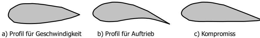
Bild 4.8 Kompromiss in den Anforderungen an ein Tragflügelprofil
