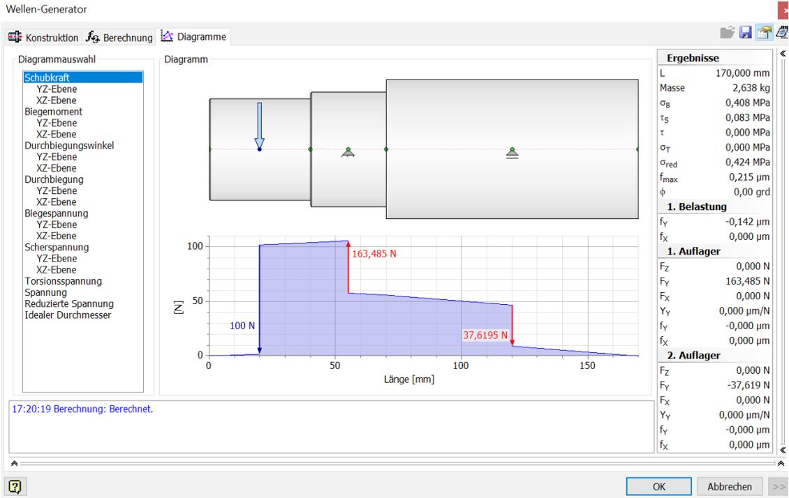
Nach Auswahl des Lagers (siehe auch Abschnitt 10.1.2) kann der Wellen-Generator über das Kontextmenü im Strukturbaum erneut geöffnet werden (**MIT KONSTRUKTIONSSASSISTENT BEARBEITEN**).
