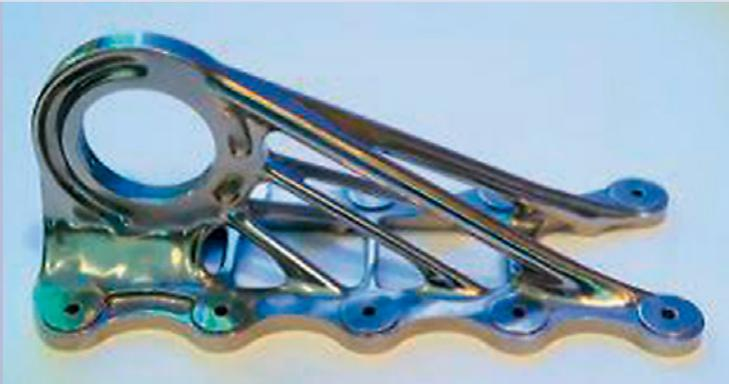
**Bild 1.11** Bionisch optimierter Halter für das Crew Rest Compartment im Airbus A350 XWB
