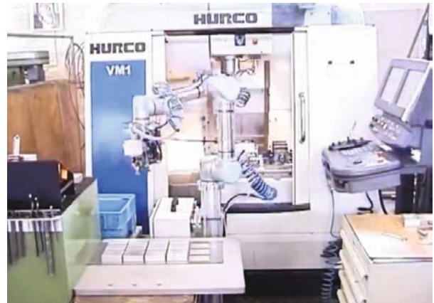
BILD 1.18 Beispiel einer einfachen Be- und Entladung durch einen Roboter
