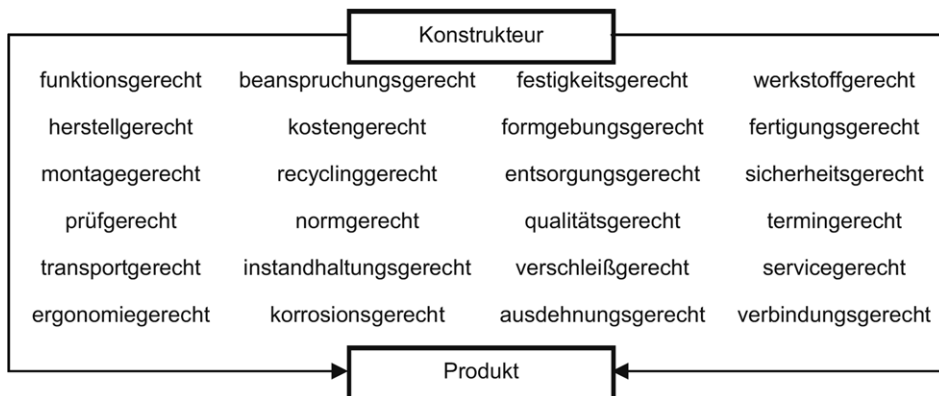
Tafel 1.1 Vom Konstrukteur für eine Maschine anzustrebende Eigenschaften [8]
