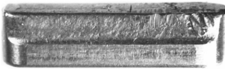
Bild 1.7 Passfeder mit Verschleißerscheinung
