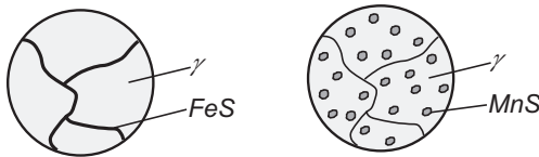
Abb. E.1-8 Anordnung von FeS- und MnS-Einschlüssen in erstarrtem Stahl
