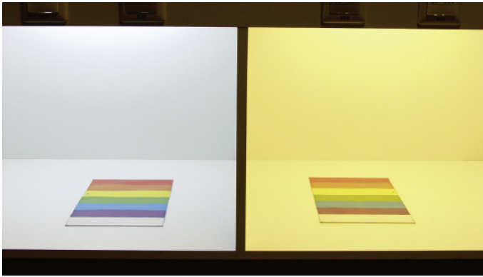
Bild 2.9 Verschiedene Lichtfarben in einem Farbmusterungskasten: linker Kasten 6500 K (Tageslichtweiß), rechter Kasten 2700 K (Warmweiß)
