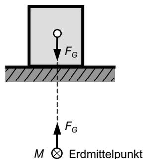
**Bild 1.3** Wechselwirkungsprinzip
