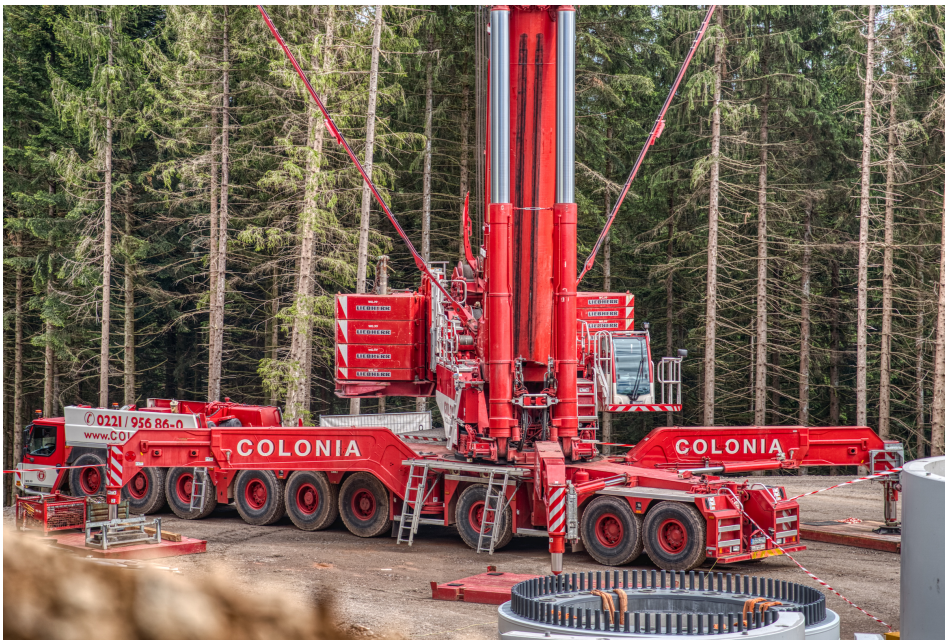
Bild 1.3 Der Ausleger wird beim LTM 1750 von zwei massiven Hydraulikzylindern aufgerichtet. Diese sind hier in der Bildmitte erkennbar. X-förmig angeordnete Stützen und viele Tonnen Gegengewicht sorgen für Standfestigkeit.
