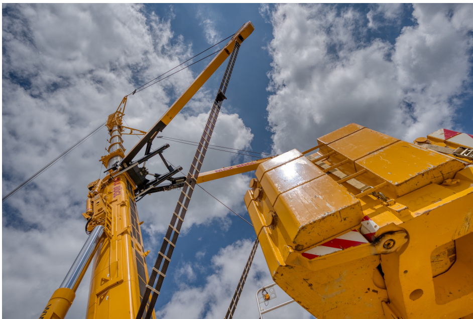
Bild 1.4 Die V-förmigen Masten auf der Oberseite des Auslegers, genannt Abspannung, dienen der Versteifung des Auslegers mittels Stahlseilen und damit zur Erhöhung seiner Biegesteifigkeit.
