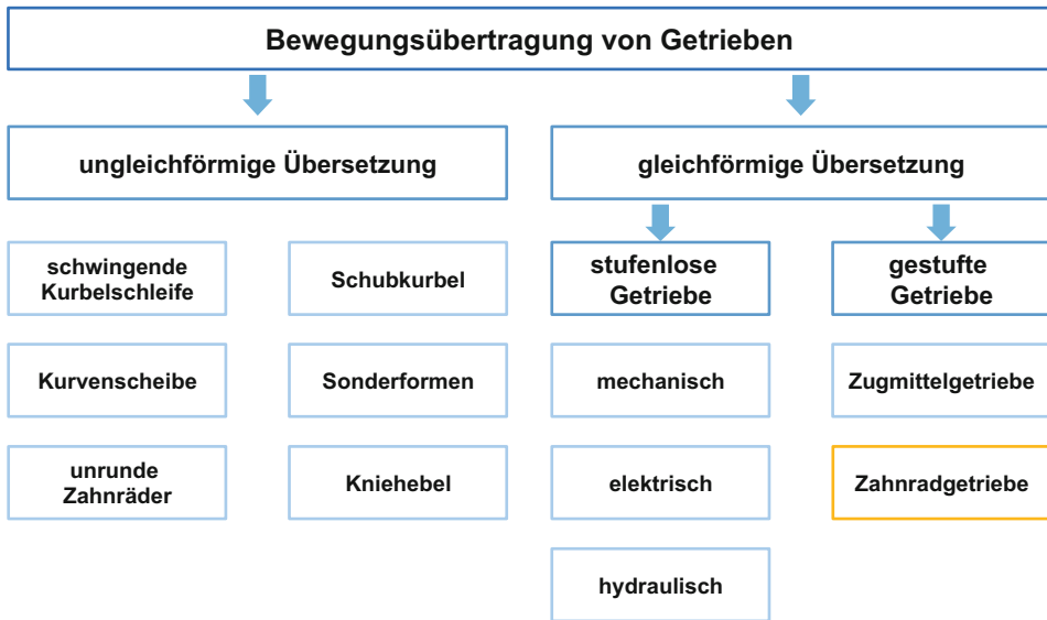
Bild 1.3 Einteilung der Getriebe nach Form der Bewegungsübertragung
