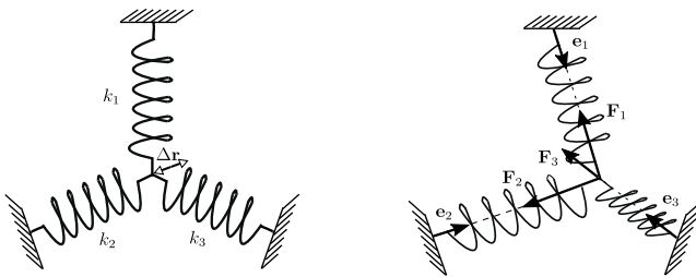
Bild 1.2 Steifigkeitstensor eines Federsystems
