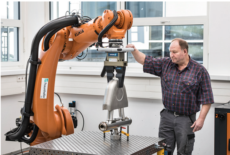
Bild 1.12 MRK-Großroboter zur Handlingsunterstützung im Future Work Lab (Quelle: Fraunhofer IPA, Rainer Bez)
