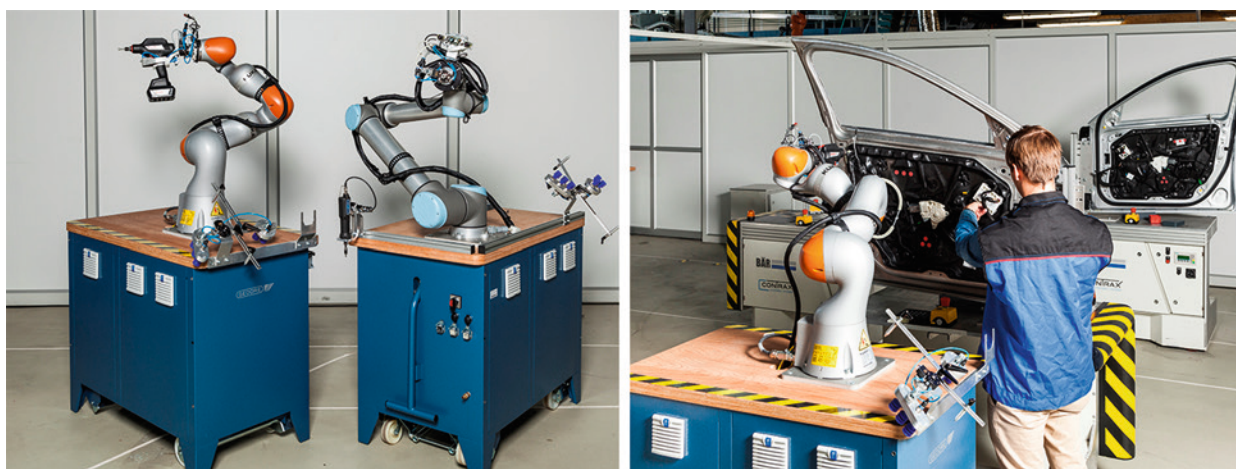
Bild 1.9 Entwicklung einer mobilen Türmontagestation mit einem MRK-Robotersystem (Quelle: ARENA2036/Rainer Bez)
