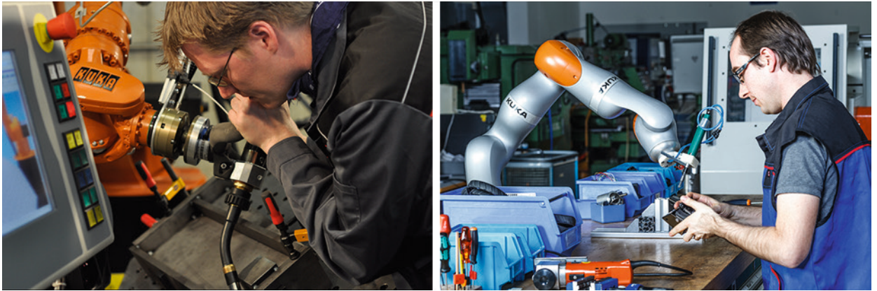
Bild 1.4 Links: Handgeführte Steuerung eines Industrieroboters durch direkte Bewegungsvergabe (Quelle: Fraunhofer IPA); rechts: der LBR als dritte Hand des Mitarbeiters (Quelle: Fraunhofer IPA)
