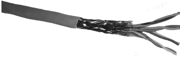
Bild 2.5 Hier sehen Sie ein aufgeschnittenes Kabel des Typs S/UTP. Deutlich sieht man die einzelnen in sich verdrehten Adernpaare. Um die Adernpaare liegt ein Mantel aus Metallgeflecht zur Abschirmung. Dies ist zwar teurer als Metallfolie, macht das Kabel aber beweglicher.
