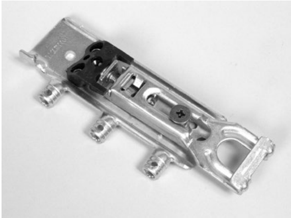
Bild 1.4 Blech-Kunststoff-Baugruppe für Hängeschrankbefestigung [45] Die komplizierte Gestaltung der Einzelteile weist auf Großserienfertigung hin. Zum senkrechten Ausrichten des Hängeschrankes ist eine Justiermöglichkeit integriert.
