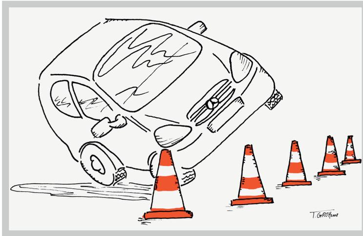
Bild 1.11: Unsicheres Fahrverhalten der A-Klasse von Mercedes
