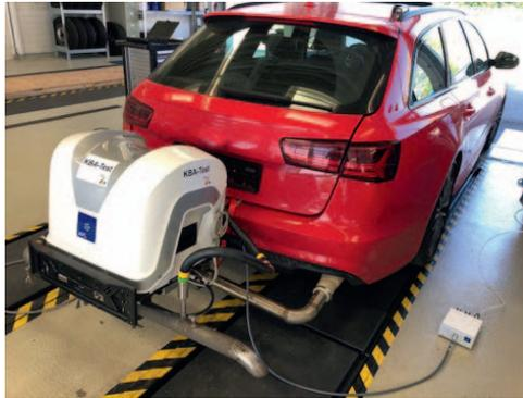
Bild 1.10: Abgastest im Fahrbetrieb [KBA 22]
