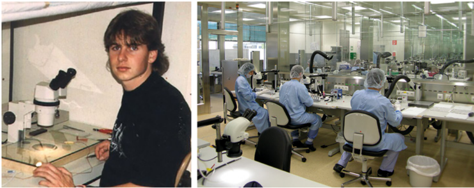
Bild 1.1 Einst und heute, Teil 1: Arbeitsplätze, an denen die Funktion der Elektroden von Gehörimplantaten getestet wird – inzwischen in Schutzkleidung. Fotos: MED-EL
