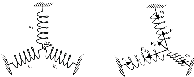
Bild 1.2 Steifigkeitstensor eines Federsystems
