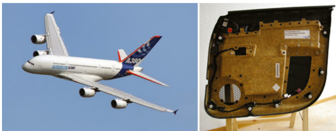
Bild 1.8 Flugzeug aus Faserverbundwerkstoff (ENAC, 2006) und Türverkleidung eines Autos aus naturfaserverstärktem Kunststoff (Gahle, 2007)
