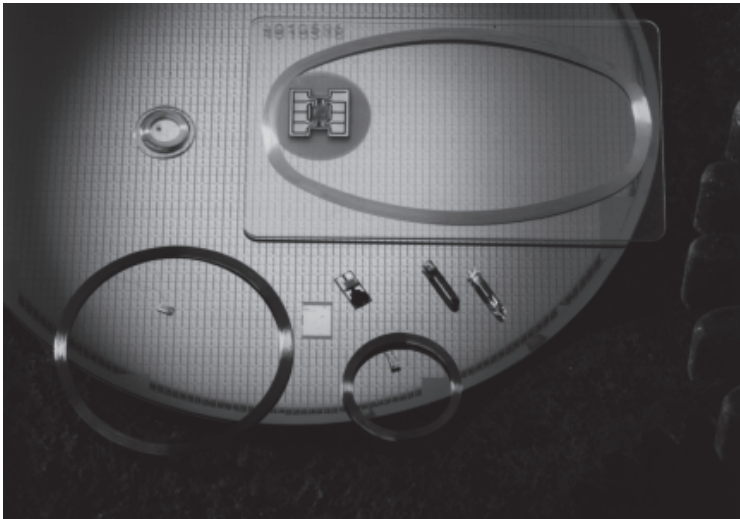
Abb. 3.14 Verschiedene Bauformen induktiv gekoppelter Transponder. Dargestellt sind Transponder-Halbzuge, also Transponder vor dem Einspritzen in ein Kunststoffgehäuse. (Foto: AmaTech GmbH & Co. KG, Pfronten)
