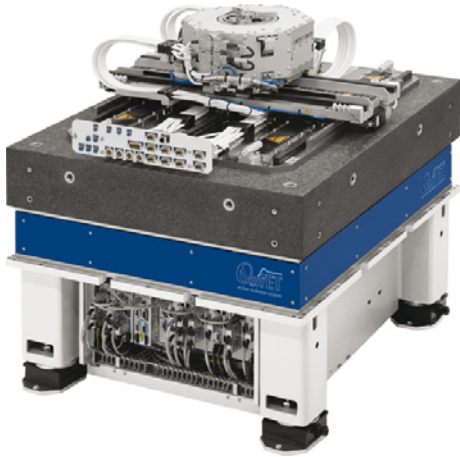
Bild 1.5 Elektrische Antriebe in einem Motion Control System für Fertigungsmaschinen der Halbleiterindustrie (© ETEL S.A.)
